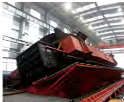
信发集团智能火车卸煤系统
